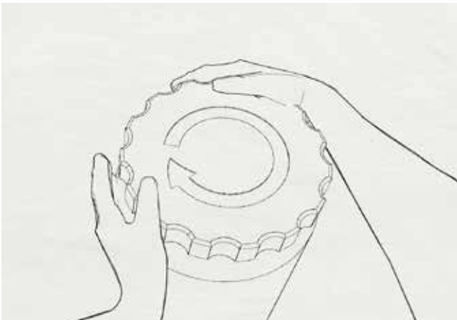
Ryc. 10 Należy unikać skrajnych pozycji nadgarstka. Szczególnie lewa ręka musi być rozciągnięta daleko w tył (odgięcie grzbietowe).
